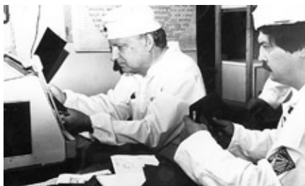
Расшифровка рентгеновских снимков. Юкконен Пентти — руководитель группы дефектоскопистов, Шнель Олег — дефектоскопист
